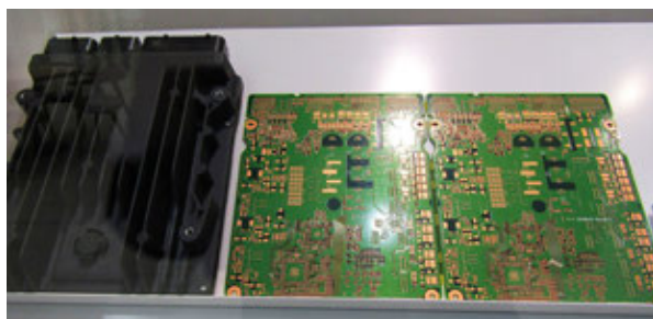
山形マイコーで生産する車載用ビルドアップ基板の例
