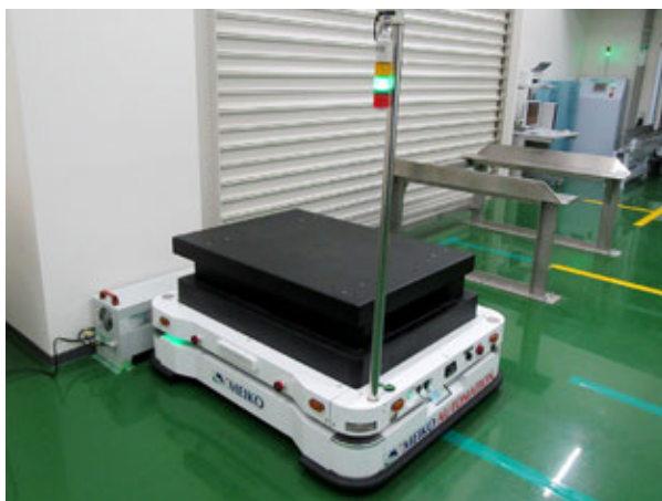
資材運搬用AGV
